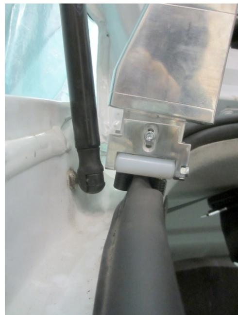
Специальный инструмент при установке резинового уплотнителя дверей автомобиля Renault Sandero
